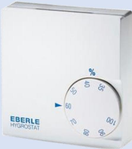
HYG 6001 je vzdialé káblové zariadenie na monitorovanie a reguláciu vlhkosti. Jednotka je namontovaná na akomkoľvek povrchu a v akejkoľvek vzdialosti od odvlhčovača, ktorý komunikuje cez signálny kábel, ktorý je priamo pripojený k elektro riadiacej skrini odvlhčovača. Umožňuje veľmi jednoduchú správu a reguláciu požadovanej úrovne vlhkosti v reálnom čase s rotačným humidistatom pracujúcim v rozsahu od 30 do 100% Rv.
