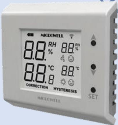
EASY 300 je vzdialé bezdrôtové zariadenie na monitorovanie a reguláciu vlhkosti a teploty vzduchu. Komunikuje bezdrôtovo prostredníctvom rozhrania 866 MHz s odvlhčovačom a dokáže nastaviť požadovanú vlhkosť a teplotu vzduchu v reálnom čase. Jednotka sa skladá z vysielača s vysoko intuitívnym digitálnym displejom, prijímačom a anténou. Prenos signálu pracuje až 30 metrov v budovách a vo voľnom priestore až 100 metrov.
