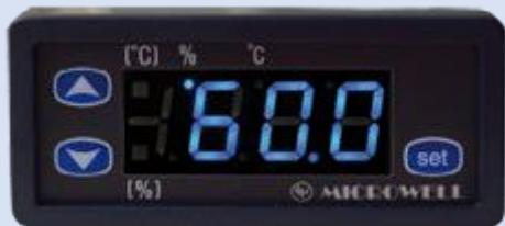
Vstavaný digitálny vlhkostat a termostat je pohodlné a presné riešenie prereguláciu teploty a vlhkosti. Dodáva sa štandardne pre všetky modely odvlhčovača bazénov DRY metal, silver a kanálového odvlhčovača DUCT. Pomáha minimalizovať spotrebu energie a udržiava ideálnu úroveň vlhkosti v akomkoľvek prostredí. Zariadenie je tiež navrhnuté tak, aby bolo intuitívne a samostatné.
